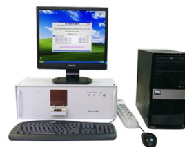
Система проверки носимой части телемеханической системы контроля бодрствования машиниста ТСКБМ (Система ПНЧ)
