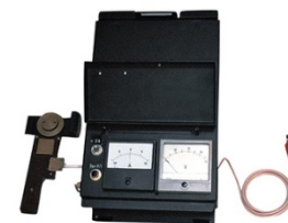
Тестер локомотивный ТЛ СПН для проверки двухпроводного ЭПТ
