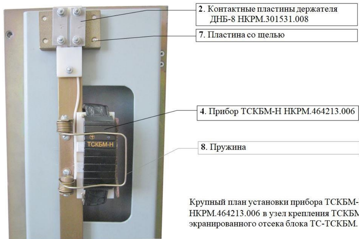
Рисунок 3.2.2.2 - Установка прибора ТСКБМ-Н НКРМ.464213.006 в узел крепления ТСКБМ-Н экранированного отсека блока ТС-ТСКБМ
