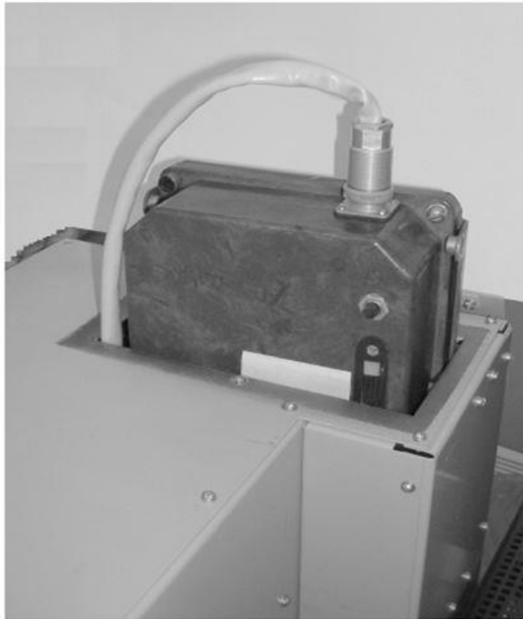
Рисунок 3.2.5.2 - Установка прибора ТСКБМ-П в экранированный отсек блока ТС-ТСКБМ
