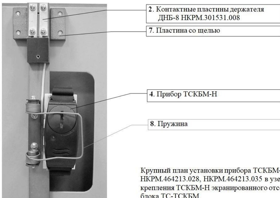
Рисунок 3.2.2.3 - Установка прибора ТСКБМ-Н в узел крепления ТСКБМ-Н экранированного отсека блока ТС-ТСКБМ
