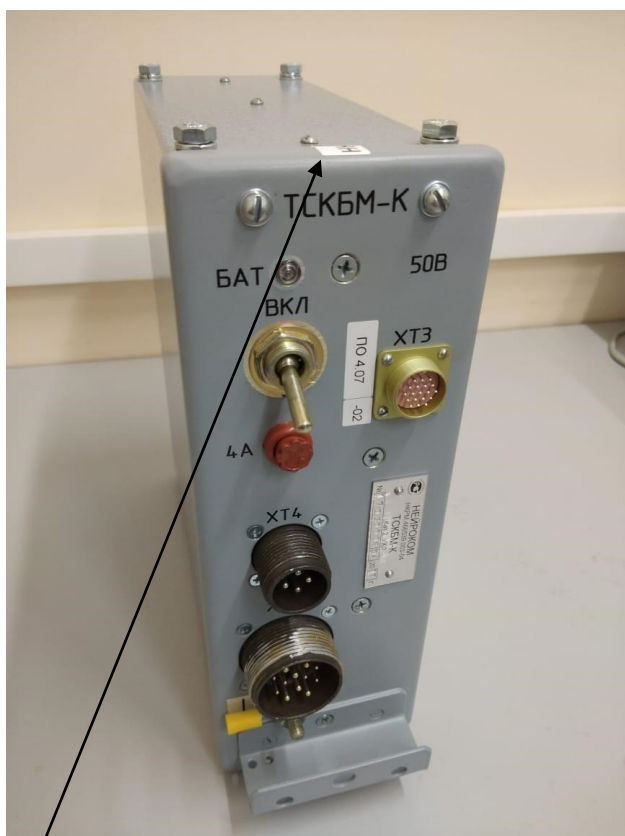
Место пломбировки от несанкционированного доступа Рисунок 7 – Блок ТСКБМ-К
