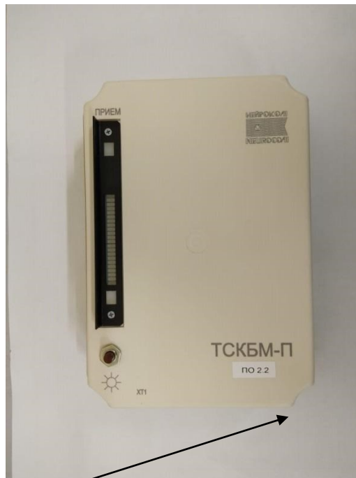
Место пломбировки от несанкционированного доступа Рисунок 6 – Прибор ТСКБМ-П
