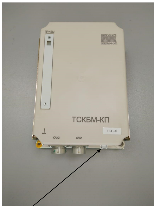
Место пломбировки от несанкционированного доступа Рисунок 8 – Блок ТСКБМ-КП
