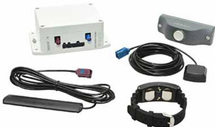
Рис. 5. Система поддержания работоспособности водителя СПРВ
