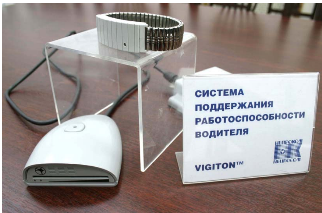
Рис.2. Датчик состояния и приемная часть системы Vigiton для поддержания работоспособности водителя во время длительных поездок и в ночное время суток.
